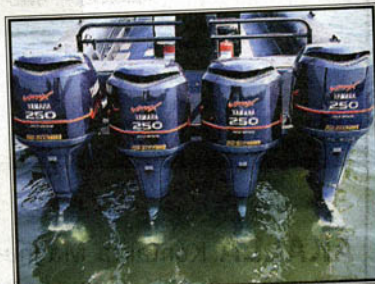
De fyra sexcylindriga Yamaha 250 V-Max (fyr-takt) ger sammanlagt 1 000 hästkrafter.
